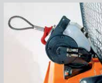
Extraction du câble avec frein sur enroulement
