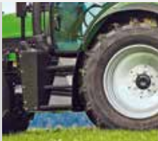
Protection du réservoir avec marches antidérapantes
