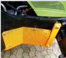
Bâti protecteur en saillie pour la cabine (défense contre les branches et grille de protection intégrée)
