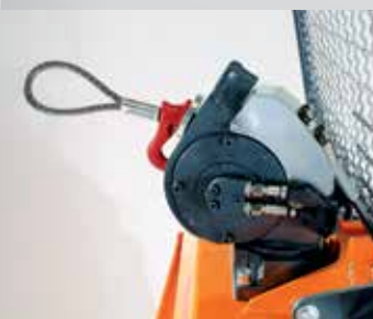
Extraction du câble
