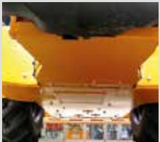
Bac de fond avec trappes d'entretien
