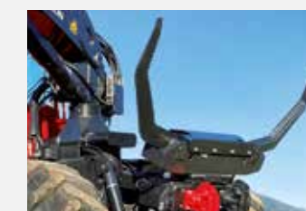
Pince portante rabattable hydrauliquement
