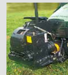
Treuil frontal à changement rapide pour un ou deux tambours
