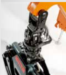
Fixation du rotateur avec frein d'oscillation
